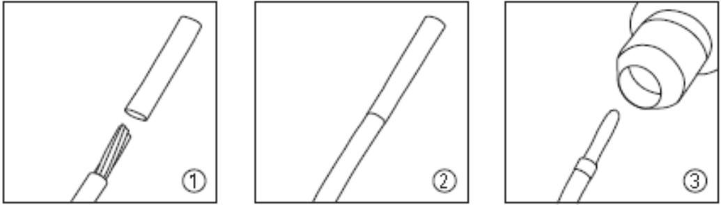
В этом случае следует придерживаться принципа: внутренний диаметр трубки до усадки должен быть больше, чем основание, на которое будет производиться усадка, на 10-20 %, а номинальный диаметр трубки после усадки должен быть меньше фактического диаметра основания на 10-20 %. Только при этих условиях будет обеспечено плотное прилегание трубки к изделию. При выборе длины следует учитывать, что ТТУ дает продольную усадку.
